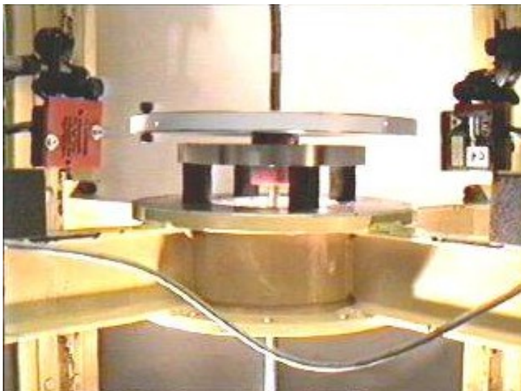
Bild 6.11: Elastische Fanglager-Aufhängung mit vier Gummifedern. Zwei Schrauben auf der Rotorscheibe (links) dienen als Unwucht.
