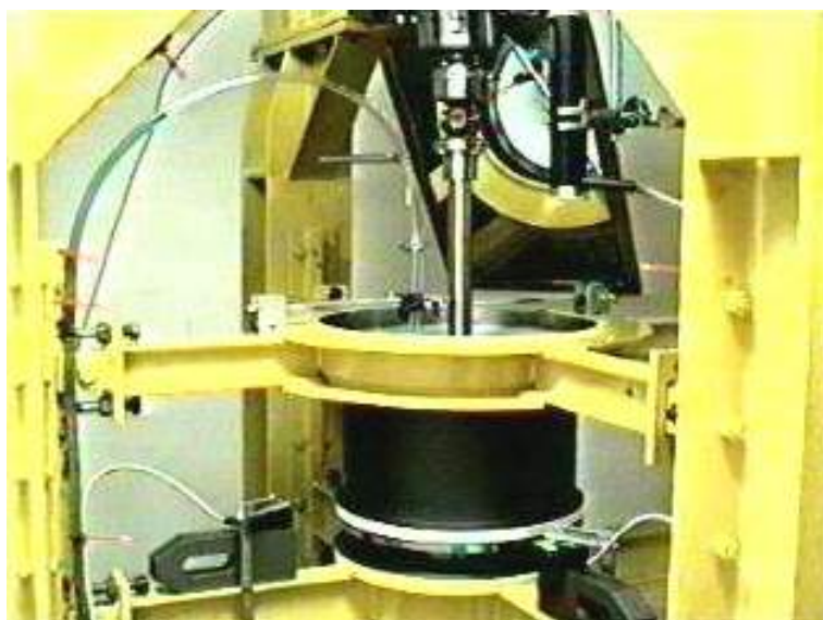
Bild 6.18: Versuchsstand mit Pendelrotor. Von oben: Kardangelenk, Welle, Kreuz mit Schutzring, Rotortrommel, Fanglagerkreuz mit Fanglager und Wegaufnehmern.
